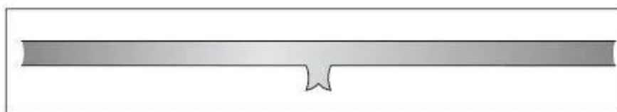
Figuur 4e: Kunststof gepolijste las
